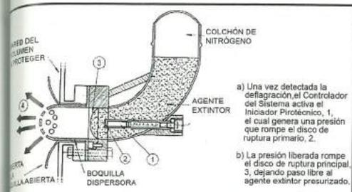
Fig. 9: Secuencia de actuación de un sistema de supresión de deflagraciones
