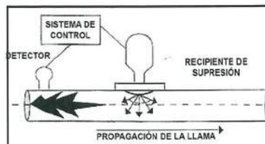
Fig. 16: Esquema de supresión de deflagraciones en tubería, mediante agente extintor
